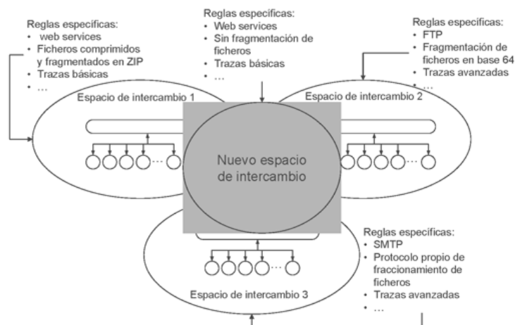
Figura 11. Ejemplo de comunicación entre sistemas de intercambio.
